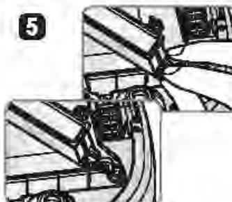
5 Appuyer sur le clip du connecteur pour séparer le câble de la batterie.
