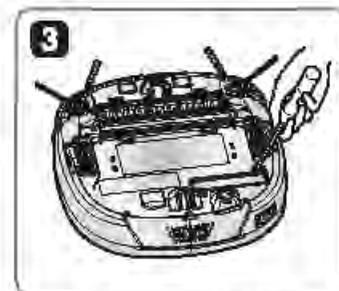
3 Utiliser un tournevis pour ôter la vis et retirer la batterie de l'appareil.
