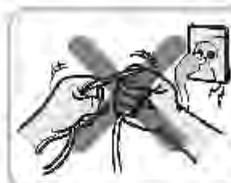
Ne pliez pas le cordon d'alimentation en forçant dessus. N'utilisez pas le cordon d'alimentation s'il a été endommagé ou détendu (étiré).
