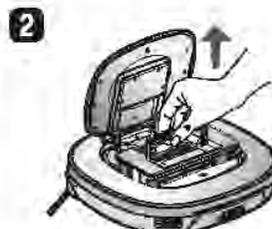
3. Tirez le crochet sur la gauche du filtre EPA situé sur l'arrière du bac à poussière pour séparer le filtre et l'éponge.
