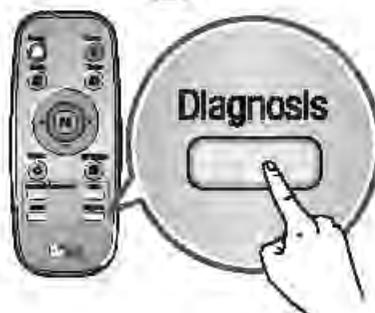
3. Si l'auto-diagnostic se termine normalement, le robot reviendra à la base et communiquera le résultat via un message vocal. Après le message vocal, appuyer sur la touche 'Home' (base) de la télécommande ou du robot peut à nouveau faire apparaître le message. Pour terminer le processus de diagnostic, appuyer sur la touche '▶' de la télécommande ou du robot.
