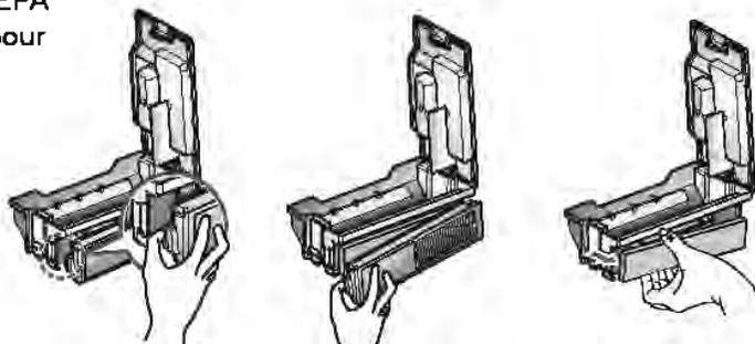
2. Nettoyez soigneusement les fines particules de poussière sur le filtre EPA avec un aspirateur ou une brosse.
