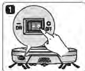
1 Couper l'alimentation au niveau de l'interrupteur principal, du côté arrière gauche de l'aspirateur robot.
