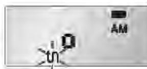
Lorsque la fonction de recherche de zone est activée, le mode de nettoyage de l'indicateur d'état clignote.
