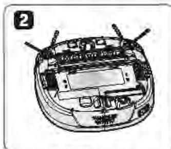
2 Placer un chiffon doux sur le sol, retirer le bac à poussière et retourner l'aspirateur robot.
