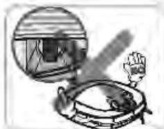
En fixant la lingette, n'obstruez pas le capteur de la caméra situé en bas de l'appareil.
