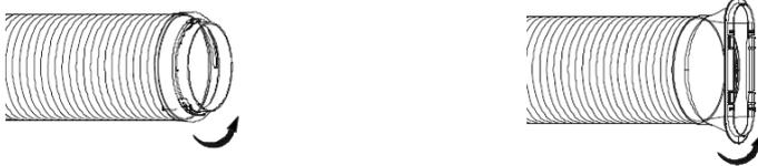
2. Insérez le connecteur d'échappement dans la sortie d'air située au dos de l'appareil.
