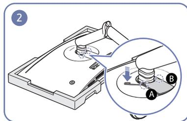
Insérez la tige de démontage dédiée dans les languettes **A** et **B**, puis utilisez la goupille comme levier pour soulever le PARTIE SECONDAIRE ARRIÈRE DU CAPOT.
