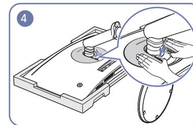
Sur l'arrière du moniteur, utilisez vos doigts pour soulever le COUVERCLE ARRIÈRE DU CAPOT dans la rainure dans le sens de la flèche, comme illustré.
