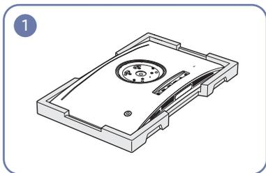
Placez la mousse de polystyrène de protection (coussin) incluse dans l'emballage sur le sol et posez le produit sur la mousse, face orientée vers le bas, comme indiqué sur l'image.
