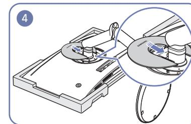
Sur l'arrière du moniteur, alignez et poussez le COUVERCLE ARRIÈRE DU CAPOT dans la rainure dans le sens de la flèche.
