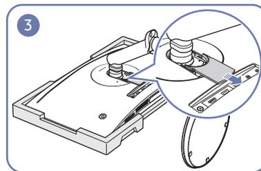
Retirez le PARTIE SECONDAIRE ARRIÈRE DU CAPOT dans le sens de la flèche.
