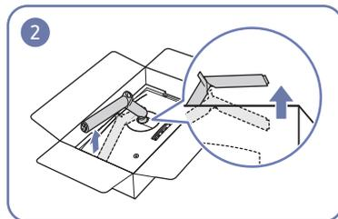
Tout en enfonçant une main dans la couche inférieure en polystyrène, soulevez le col du socle avec l'autre main.
