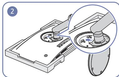
Fixez le socle à l'arrière du moniteur dans le sens de la flèche.
