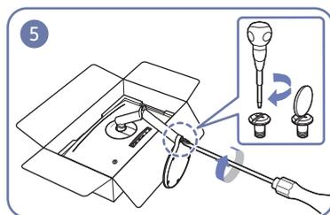
Fixez la base du socle au col du socle puis attachez les deux vis à la base pour la fixer solidement.
