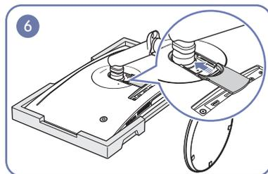
Sur l'arrière du moniteur, alignez et poussez la PARTIE SECONDAIRE ARRIÈRE DU CAPOT dans la rainure dans le sens de la flèche.
