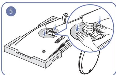
Poussez le COUVERCLE ARRIÈRE DU CAPOT dans le sens des flèches.
