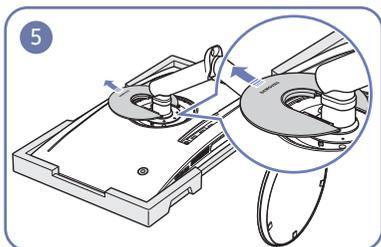
Retirez le COUVERCLE ARRIÈRE DU CAPOT dans le sens de la flèche.
