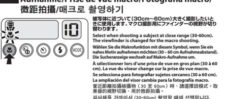
被写体に近づいて(30cm-60cm)大きく撮影したいときに使用します。マクロモードにカメラの液晶画面が切り替わります。
