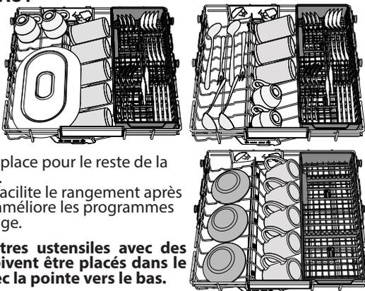
**Les couteaux et autres ustensiles avec des bords tranchants doivent être placés dans le panier à couvert avec la pointe vers le bas.**
