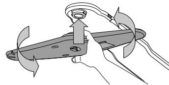
Le gicleur supérieur peut être enlevé en le comprimant vers le haut puis en le tournant dans le sens contraire aux aiguilles d'une montre. Le remontage du gicleur s'effectue en le tirant vers le haut et en le tournant dans le sens des aiguilles d'une montre.
