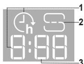
1. **Temps restant au sol** - indicateur de temps restant jusqu'au démarrage du cycle, lorsque l'option Départ différé est activée
