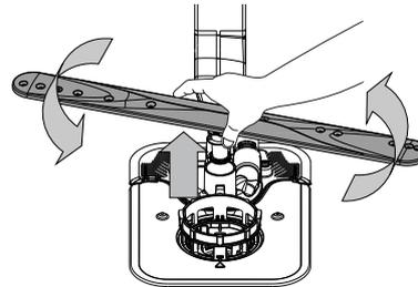
Le gicleur inférieur peut être enlevé en le tirant vers le haut et en le tournant dans le sens contraire aux aiguilles d'une montre. Le remontage du gicleur s'effectuant en le tirant vers le bas et en le tournant dans le sens des aiguilles d'une montre.
