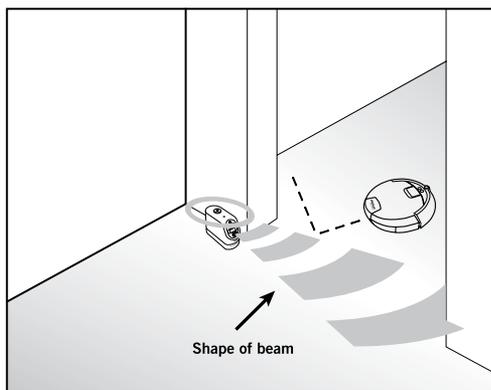
Les Virtual Wall nécessitent 2 batteries « D ». Ils s'éteignent automatiquement à la fin de chaque cycle de nettoyage.
