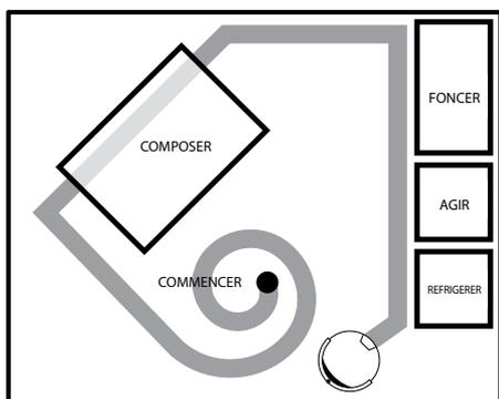
Scooba alternera ses programmes entre le nettoyage en spirale, en suivant le mur et en traversant la pièce au cours d'un même cycle de nettoyage.
