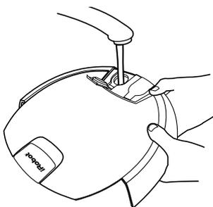
**⚠** Si les attaches de la batterie ne sont pas dans les trous de guidage, dans son emplacement, le réservoir et la base du robot peuvent ne pas être correctement raccordés.
