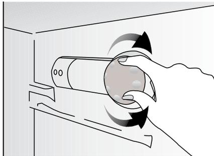
La température de fonctionnement est réglée à l'aide de la commande de température.
