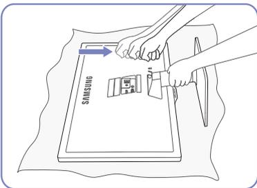
Tout en maintenant le montant du support d'une main, tapez vers le bas avec le poing sur le haut du support en direction de la flèche pour l'enlever.
