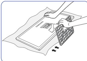
Soutenez le corps de l'appareil avec votre main comme le montre l'illustration. Poussez le pied monté dans le corps de l'appareil, dans le sens de la flèche, comme le montre l'illustration.
