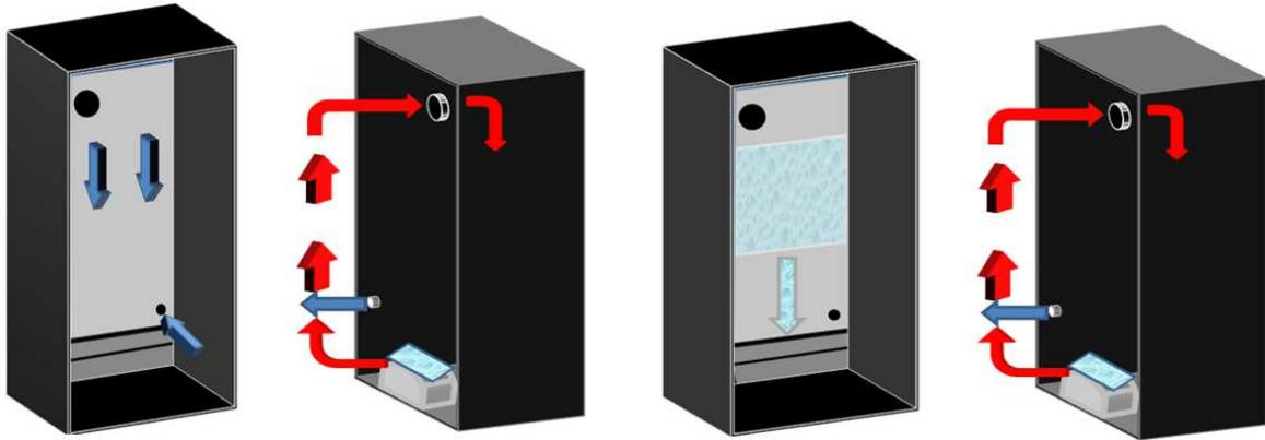
L'appareil produit du froid, qui plus lourd que l'air chaud, descend lentement. Cela crée donc une pression et chasse l'air par le trou situé en partie basse.
