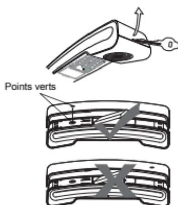
**La batterie et le couvercle doivent être placés dans le bon sens :**
