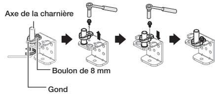
8. Fixez la charnière sur le côté inférieur droit du congélateur, à l'emplacement où les boulons ont été retirés (étape 6). Vissez les boulons retirés précédemment sur le côté inférieur gauche du congélateur pour un usage ultérieur. Inversez le pied de la gauche vers la droite.
