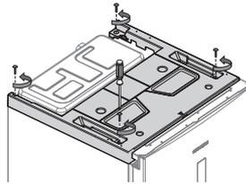
2. Retirez le capot en plastique et assurez-vous de débrancher le câble qui est connecté à ce capot. Une fois le capot en plastique retiré, vérifiez les pièces permettant d'inverser la porte.
