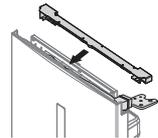
15. Enlevez le cache de la poignée et retirez les vis ; veillez à ôter les protections et la poignée du côté droit pour les installer sur le côté gauche de la porte. (Veillez à couvrir le côté droit avec les protections récupérées.)
