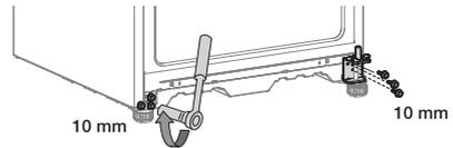
9. Retirez les vis des parties inférieures droite et gauche de la porte du congélateur. Changez la butée de porte de côté, de la gauche à la droite. Le gond doit également être interverti.
