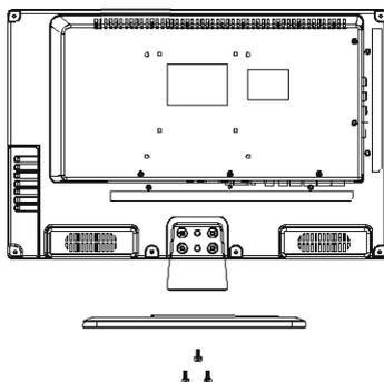
3. Resserrez les vis  $\Phi$  4x12 fournies pour fixer solidement la base du téléviseur en position. (3 vis ont incluses avec la TV).
