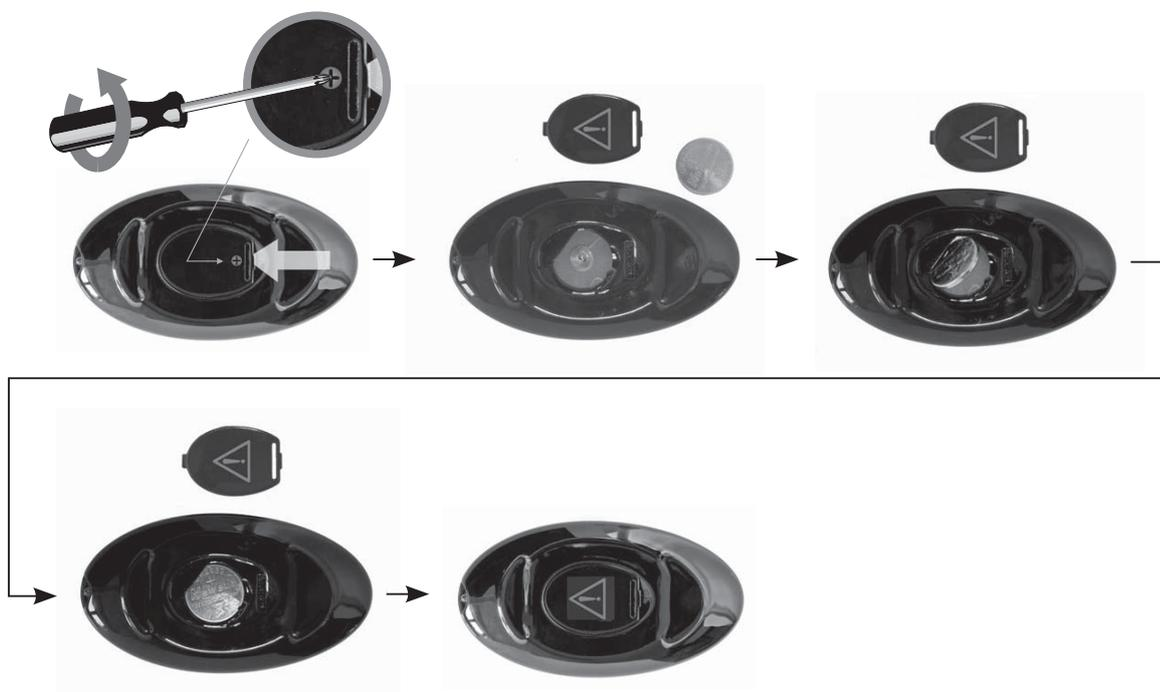
Remplacement de la pile bouton type CR-2025 : retourner la télécommande, dévisser la vis, enlever le couvercle, enlever la pile usagée, insérer la pile neuve, coté marquée "+" vers l'extérieur, remettre le couvercle, resserrer la vis.
