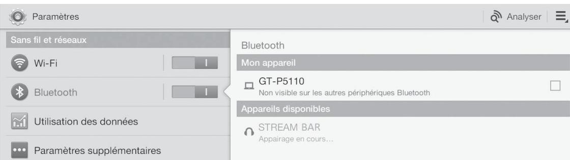
Si le message «Connexion...» n'apparaît pas, vérifiez qu'un autre appareil n'est pas déjà connecté au STREAM BAR. Déconnecter cet appareil et appuyer une nouvelle fois sur "Cabasse STREAM BAR". Votre STREAM BAR est maintenant connectée.
