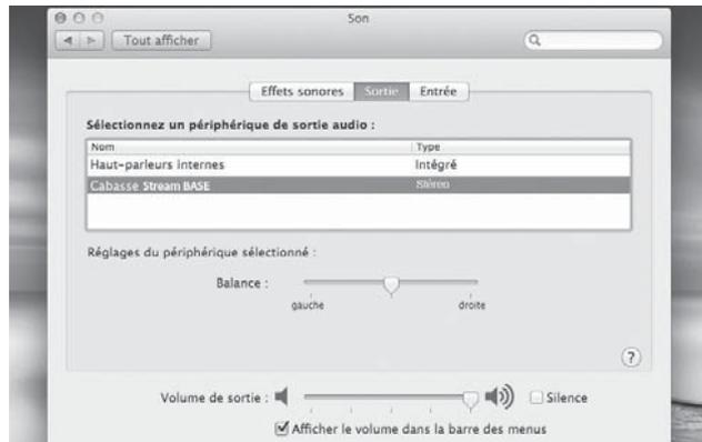
Sélectionner l'onglet "Sortie" puis la ligne "STREAM BAR stereo". Le lecteur "STREAM BAR" dans cette fenêtre correspond à la configuration mains libres pour smartphones, inappropriée à l'écoute musicale.
