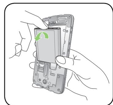
5. Insérez votre carte micro SIM dans sa fente, puis remplacez la batterie et le couvercle.
