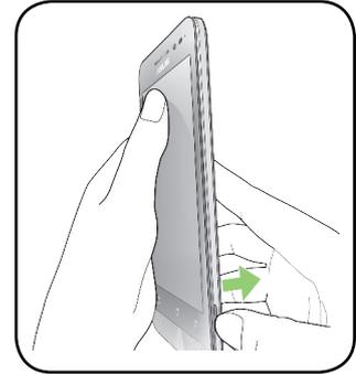
3. Désengagez lentement le couvercle arrière de la coque de l'appareil.
