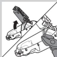
**4** Sortez le support de la batterie et coupez les fils de la batterie à l'aide d'une pince coupante.
