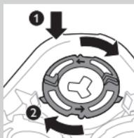
**8** Remettez les anneaux de fixation en place sur le support de la tête de rasage et tournez-les dans le sens des aiguilles d'une montre.
