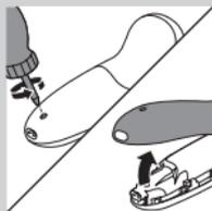
Soyez prudent car les languettes des batteries sont coupantes.
