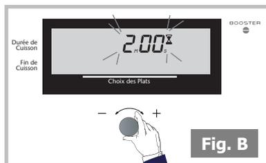
L'afficheur s'arrête de clignoter au bout de quelques secondes, la minuterie se met en marche et décompte le temps de seconde en seconde.
