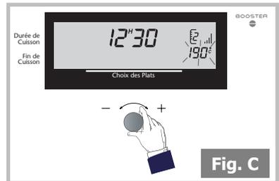
La validation du réglage de température se fait automatiquement après quelques secondes.
