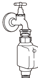
tuyau d'arrivée d'eau de sécurité
