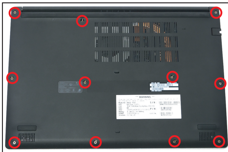
Figure 1-2. Retrait du couvercle de la base
