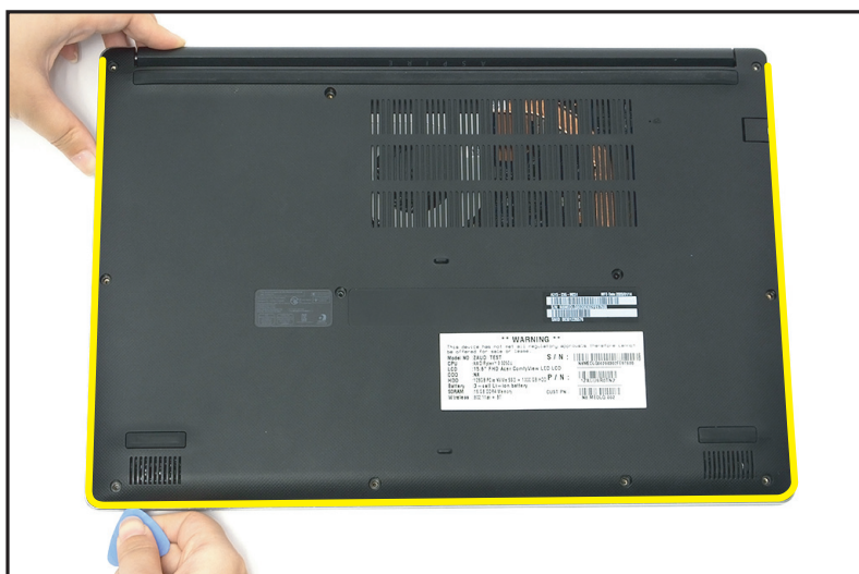
Figure 1-3. Retrait du couvercle de la base
