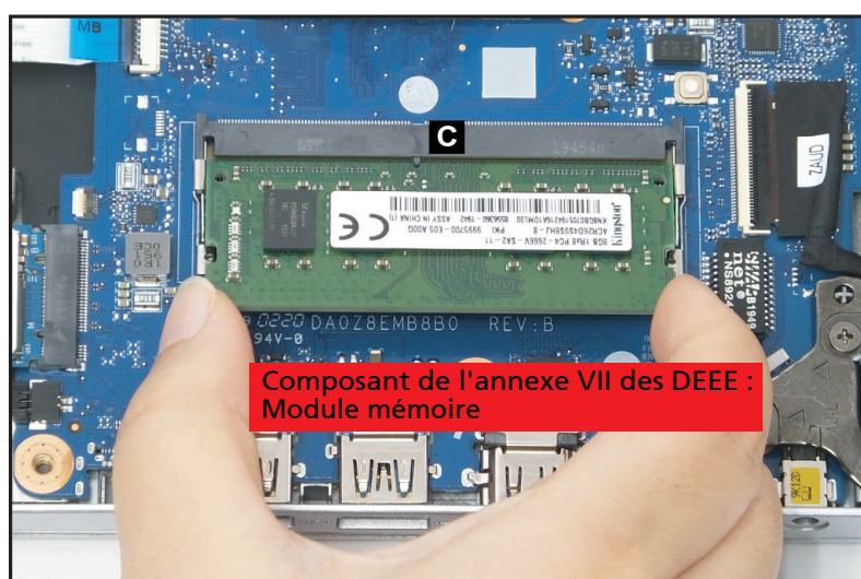
Figure 1-15. Retrait du module DIMM
