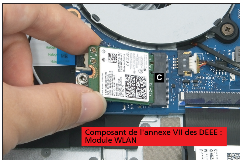
Figure 1-10. Retrait du module WLAN
