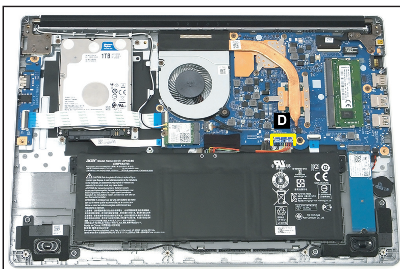
Figure 1-6. Retrait de la batterie
