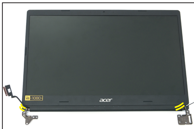
Figure 1-35. Retrait de la face du LCD
