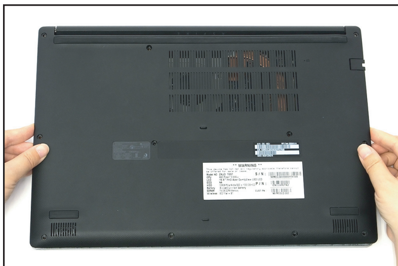
Figure 1-4. Retrait du couvercle de la base
