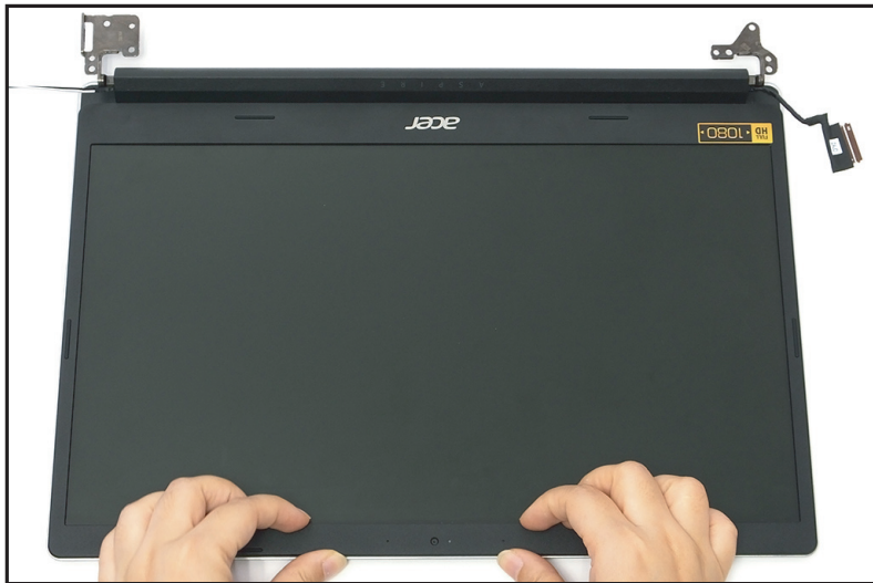
Figure 1-36. Retrait de la face du LCD
