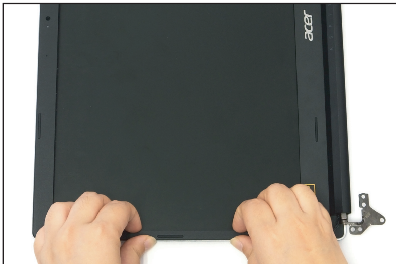
Figure 1-37. Retrait de la face du LCD
