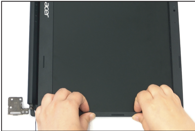
Figure 1-38. Retrait de la face du LCD
