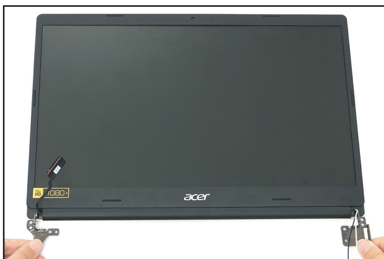
Figure 1-34. Retrait de la face du LCD
