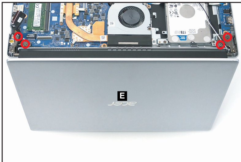
Figure 1-12. Retrait du module LCD
