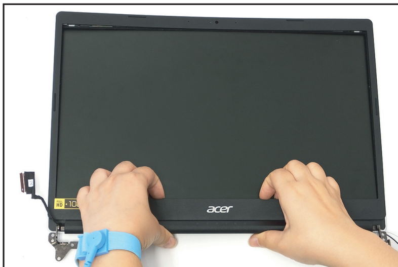
Figure 1-39. Retrait de la face du LCD
