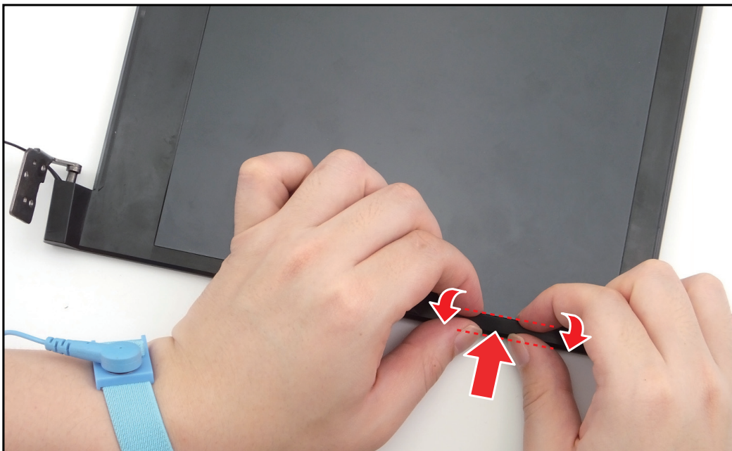
Figure 1-35. Retirer l'encadrement LCD (1 sur 8)
