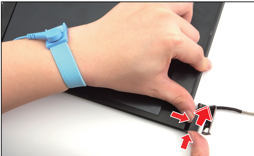
Figure 1-40. Retirer l'encadrement LCD (6 sur 8)
