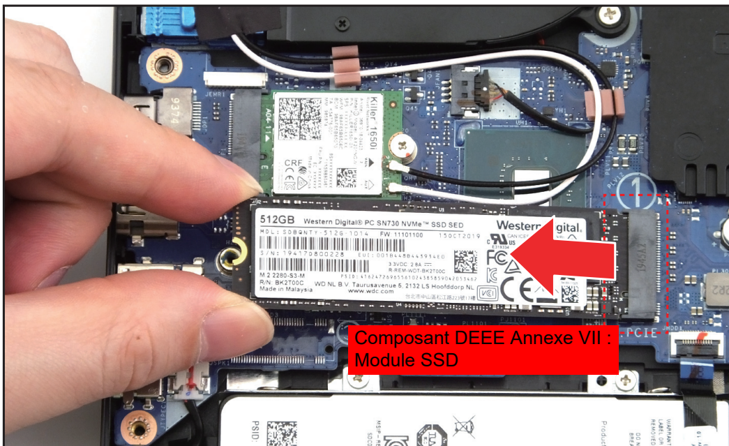
Figure 1-14. Retirer le module SSD 1
