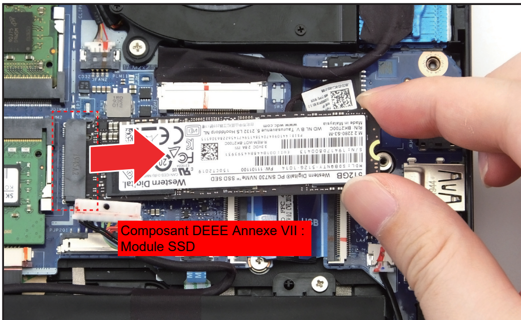
Figure 1-16. Retirer le module SSD 2
