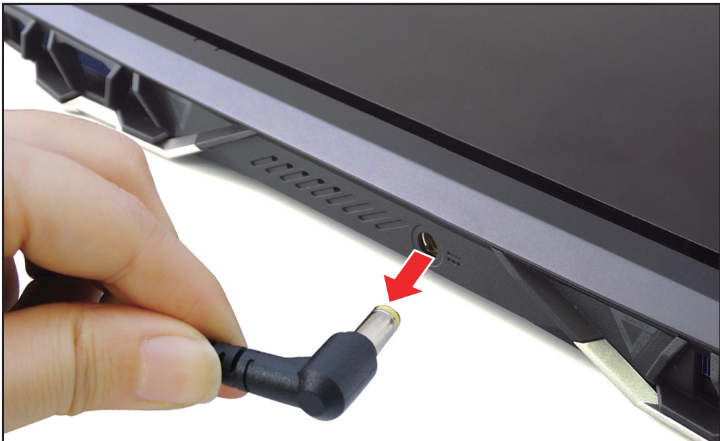
Figure 1-1. Débrancher l'adaptateur secteur
