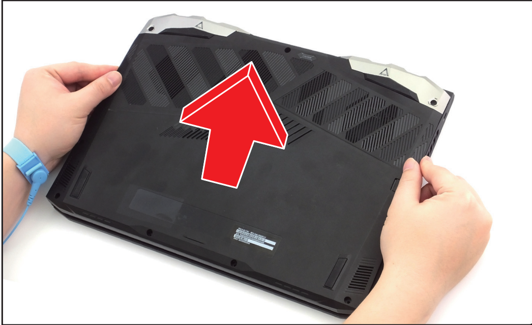
Figure 1-4. Libérer le boîtier inférieur (2 sur 2)
