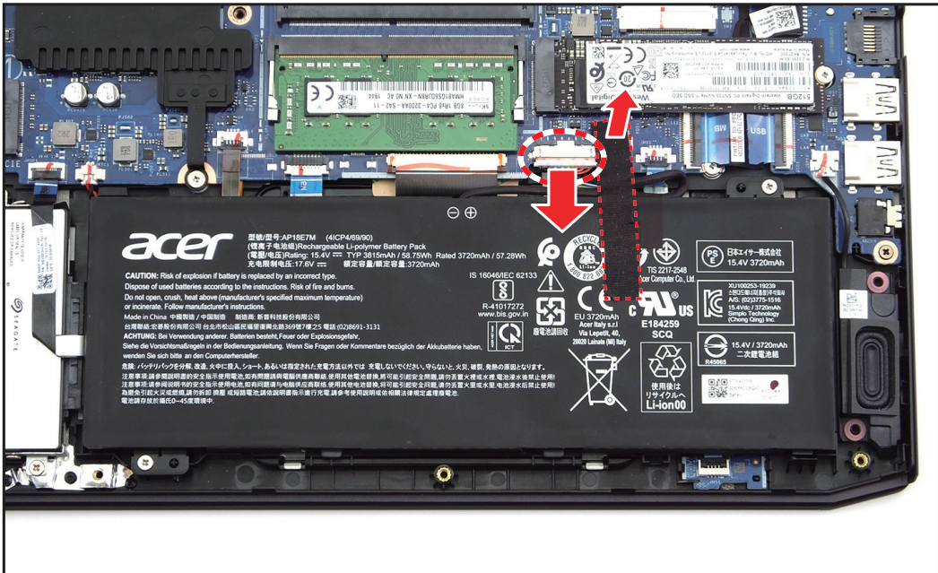
Figure 1-5. Débrancher le câble de la batterie
