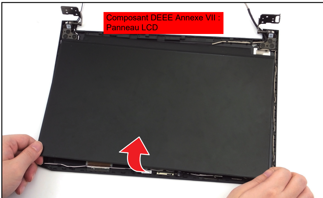
Figure 1-44. Faire apparaître le connecteur du câble eDP
