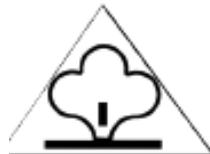
Le symbole "vapeur" dans un triangle équilatéral est destiné à alerter l'utilisateur de la présence d'un jet de vapeur important et à prendre toutes les précautions nécessaires contre les brûlures.
