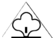
Il simbolo "Vapore" all'interno di un triangolo equilatero avverte l'utente della presenza di un importante getto di vapore e di prendere tutte le precauzioni necessarie al fine di evitare ustioni.
