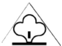
Das Symbol "Dampf" innerhalb des gleichseitigen Dreiecks weist den Benutzer auf das Vorhandensein des wichtigen Dampfstrahls und darauf hin, alle notwendigen Vorsichtsmaßnahmen gegen Verbrennungen zu treffen.
