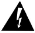
Le flash avec le symbole en forme d'éclair dans un triangle équilatéral est destiné à alerter l'utilisateur de la présence d'une tension dangereuse non isolée à l'intérieur du produit, qui peut être d'une amplitude suffisante pour constituer un risque de choc électrique pour les personnes.
