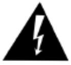
Das Blitzsymbol mit Pfeilspitze in einem gleichseitigen Dreieck weist den Benutzer auf das Vorhandensein einer nicht isolierten gefährlichen elektrischen Spannung innerhalb des Systemgehäuses hin, die ausreichend hoch sein kann, um eine Gefahr von Stromschlägen darzustellen.
