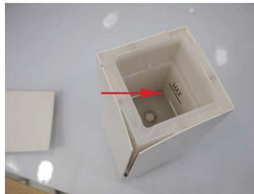
Remplissage de l'eau
