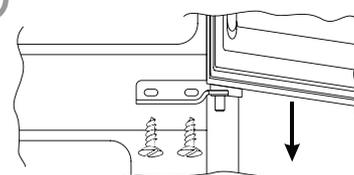
Retirez les caches (A) et (B), desserrez les vis et enlevez partiellement le bandeau.
