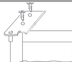
Retirez le cache du côté gauche et insérez-le dans les inserts du milieu et du bas sur le côté droit.
