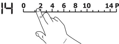
Appuyez sur le bandeau de commande sur le niveau de cuisson souhaité. Corrigez-le au besoin en effleurant une autre position, à droite ou à gauche. Ne relâchez pas la pression tant que le niveau de cuisson souhaité n'est pas atteint. L'affichage indique le niveau de cuisson.
