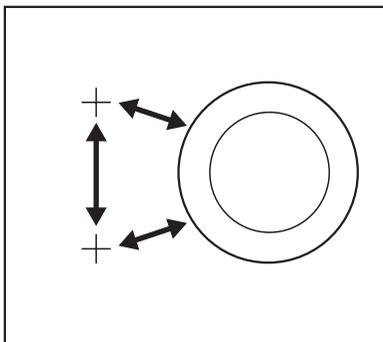
Le dispositif de gestion de la puissance répartit la puissance disponible entre deux zones de cuisson qui sont couplées pour former une paire (voir la figure). La fonction Booster attribue la puissance maximale à l'une des zones de cuisson de la paire et réduit automatiquement la puissance de l'autre zone au minimum. L'écran de la zone correspondante affiche plusieurs valeurs en alternance.
