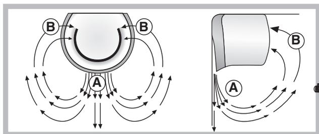
L'A.I.R. System permet une conservation optimale des aliments en rétablissant très rapidement la température après chaque ouverture de porte et en la distribuant parfaitement à l'intérieur du compartiment : l'air soufflé (A) refroidit au contact de la paroi froide, tandis que l'air plus chaud (B) est aspiré (voir *figure*).
