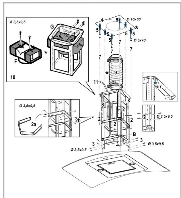
12. Appliquer les dés de fixation fournis à l'intérieur des parties des cheminées supérieures et inférieures en correspondance des fentes rectangulaires, au total 14 dés doivent être installés.
