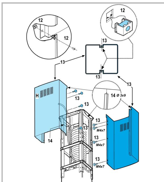
15. Accoupler les deux parties inférieures de la cheminée en couverture du treillis, utiliser 6 vis (3 par côté- voir aussi le plan pour l'accouplement des deux sections).
