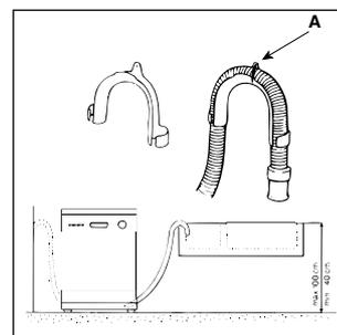
**⚠ Attention:** le coude spécial en plastique doit être solidement fixé au mur pour éviter que le tuyau d'évacuation ne se déplace et ne déverse l'eau par terre.
