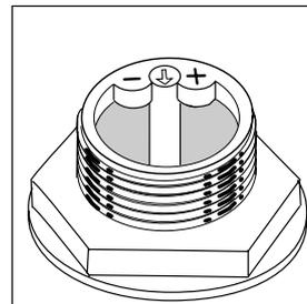
2) Une flèche est située sur le collier du réservoir (voir fig. à côté), si nécessaire, tournez, dans le sens inverse des aiguilles d'une montre, la flèche du signe "-", vers le signe "+" selon la dureté de l'eau d'alimentation.
