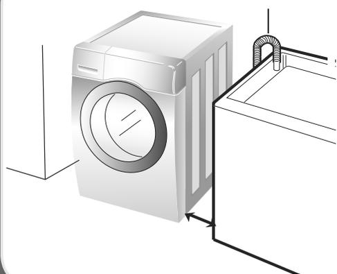
**Sol à niveau** : L'inclinaison du sol doit être inférieure à 1°.
