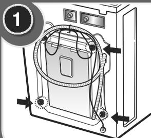
**1** Ces vis sont utilisées pour sécuriser le transport. Elles doivent impérativement être retirées avant la mise en service de l'appareil afin d'éviter tous dysfonctionnements tels que d'importantes vibrations ou des nuisances sonores.
