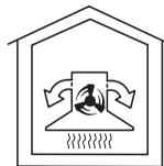
L'air aspiré passe à la fois par les filtres à graisses et par un **filtre à charbon actif**. L'air recyclé est renvoyé dans la cuisine par des orifices dans le conduit de la hotte.
