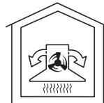
L'air aspiré passe à la fois par le filtre à graisses et par un **filtre à charbon actif**. L'air recyclé est renvoyé dans la cuisine par des orifices dans le conduit de la hotte.
