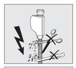
Le tuyau d'arrivée ne doit **pas** être raccourci ou abîmé étant donné qu'on y trouve des éléments sous tension (voir croquis).
