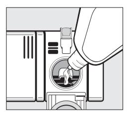
■ Versez le produit jusqu'à ce qu'il devienne visible à la surface de l'ouverture de remplissage.
