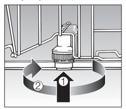
■ Pressez le bras d'aspersion du milieu ①, de façon à ce que l'engrenage s'encrante et dévissez-le ②. ■ Sortez le panier inférieur.
