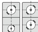
Les zones avant et arrière, qui possèdent deux inducteurs chacune, peuvent être utilisées indépendamment en réglant la puissance nécessaire de chacune ; il est alors recommandé d'utiliser uniquement un récipient par zone.
