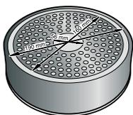
Afin d'obtenir de bons résultats de cuisson, le diamètre de la surface ferromagnétique doit, de préférence, être adapté à la taille de la zone de cuisson. Si le récipient n'est pas détecté sur une zone de cuisson, l'essayer sur la zone de diamètre immédiatement inférieure.
