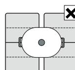
Pour les plaques ayant plus d'une zone flexible, il est recommandé de ne pas utiliser plusieurs zones en même temps pour un même récipient.
