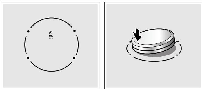
Le panneau rotatif est la zone de programmation où les zones de cuisson et les niveaux de puissance peuvent être sélectionnés à l'aide du bouton de commande rotatif. Dans la zone du panneau rotatif, le bouton de commande rotatif se centre automatiquement.
