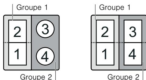
**Remarque :** La fonction Powerboost peut être activée dans la zone flexible lorsqu'elle est utilisée comme zone de cuisson unique. Pour cela, placer le récipient au centre de la zone, comme indiqué dans le chapitre *Zone flexible*.
