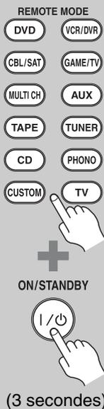
**Tout en maintenant enfoncé le bouton REMOTE MODE du mode dans lequel vous souhaitez utiliser la commande, maintenez enfoncé le bouton [ON/STANDBY] jusqu'à ce que le bouton REMOTE MODE s'allume (environ 3 secondes).**
