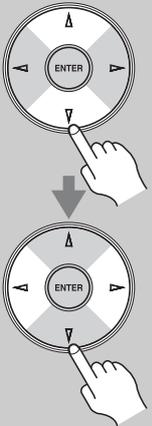
**Utilisez les boutons haut et bas [▲]/[▼] pour sélectionner « FPB du LFE », puis utilisez les boutons gauche et droite [◀]/[▶] pour sélectionner une fréquence de filtre passe-bas.**
