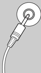
Placez le microphone de configuration d'enceintes au point de mesure ① (page 50) et branchez-le à la prise SETUP MIC.
