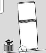
Si le réfrigérateur penche vers la droite, tournez le pied avant droit dans le sens inverse des aiguilles d'une montre.
