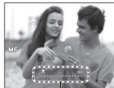
Barre de contrôle de la mise au point manuelle
