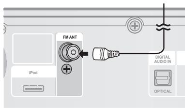
1. Connectez l'antenne FM fournie à la prise COAXIALE FM de 75Ω.
