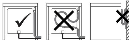
Effectuez le raccordement au réseau de distribution du gaz à l'aide d'un tuyau en caoutchouc conforme aux caractéristiques visées par la norme en vigueur (vérifiez que le sigle de la norme est bien imprimé sur le tuyau).
