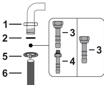
Vissez soigneusement le raccord 3 au raccord du gaz 1 de l'appareil en interposant toujours le joint 2 fourni.
