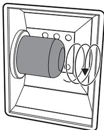
5. Remplacez l'ampoule par une ampoule identique (25W).
