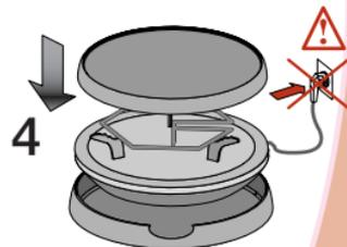
Assembler l'appareil en plaçant le socle amovible **sous** la partie chauffante et en posant la plaque grill sur la résistance.
