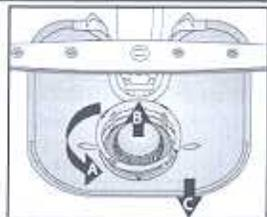
Dévissez le corps cylindrique du filtre, dégagez-le avec le filtre à petits grains...
