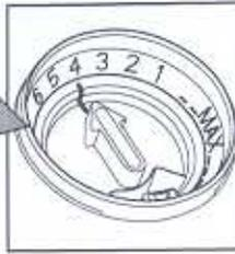
La quantité de liquide de rinçage peut être adaptée au détergent utilisé. Plus le réglage est bas, plus la quantité de liquide de rinçage utilisée sera faible (réglage d'usine : position 4). Appuyez sur la touche pour ouvrir le couvercle B. À l'aide d'une pièce de monnaie ou de tout objet similaire, faites tourner la flèche dans la position souhaitée. Dès que vous avez modifié la quantité de liquide de rinçage, refermez le couvercle.
