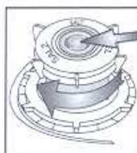
Vissez le bouchon. Éliminez les résidus de sel autour du bouchon. Certains réservoirs à sel ont un indicateur de niveau intégré dans le bouchon (voir comment contrôler ci-dessus).
